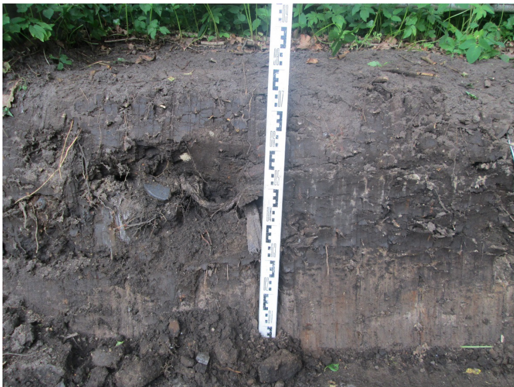
Dieptebepaling putwand 09 met plaatselijk resten puin / stortmateriaal
