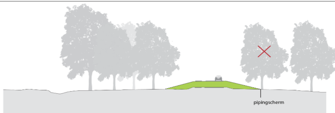
Figuur 7-2 Indicatief dwarsprofiel dijksectie 1A (nabij N271)
