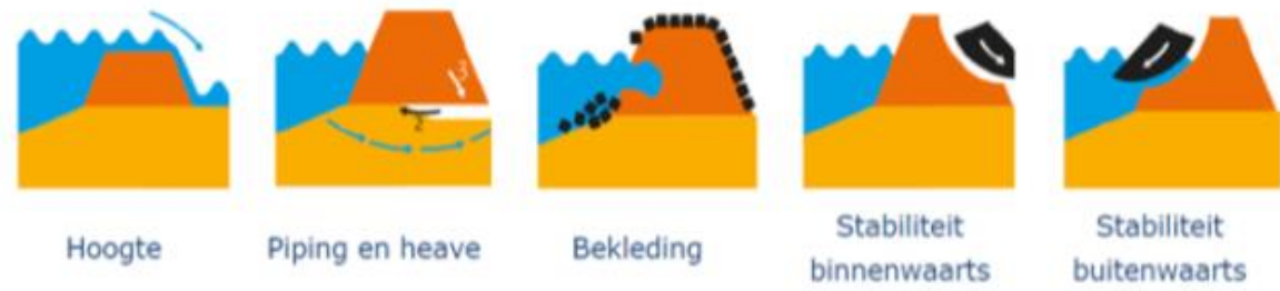
Figuur 0-1 Werking van de verschillende faalmechanismen
