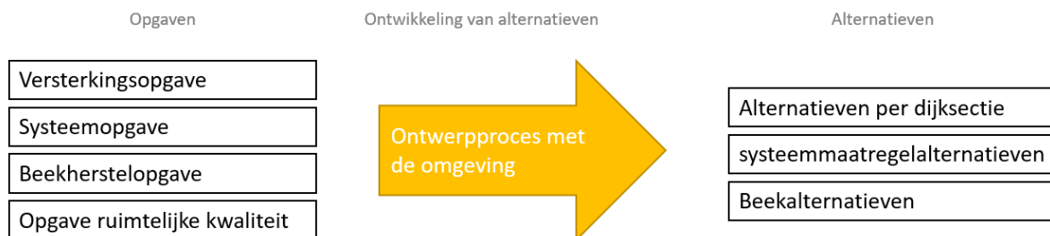
Figuur 3-3 Schematische weergave van het ontwerpproces voor het dijktraject Arcen met links de verschillende opgaven en rechts de alternatieven.
