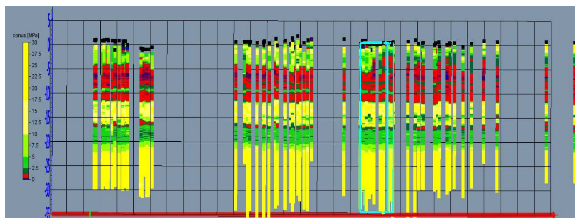
Figuur 4-1 Doorsnede op basis van conusweerstand (verticale as diepte in m NAP)
