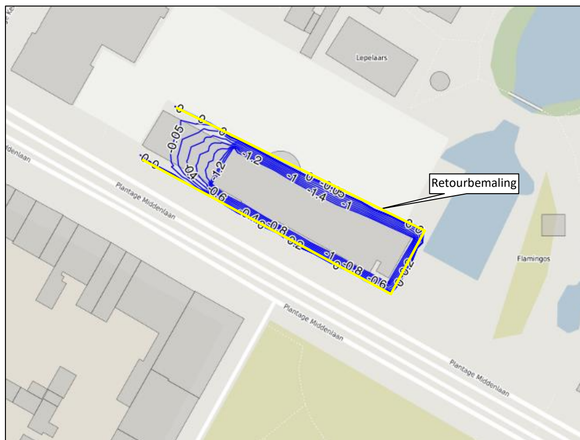
Figuur 11 – Stijghoogteverlagingen tweede watervoerend pakket (laag 3) onder GLS-omstandigheden , i.c.m. retourbemaling in het tweede watervoerend pakket (laag 3).
