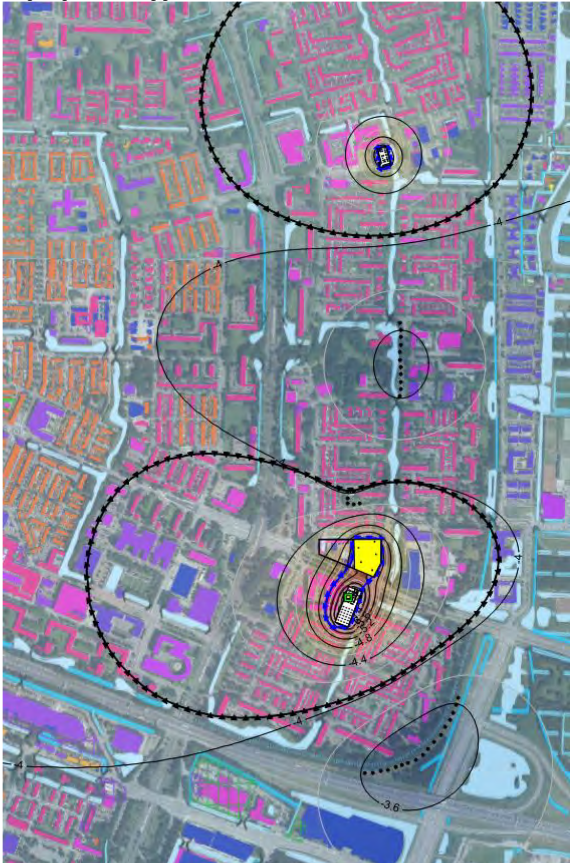
Figuur 4 - stationaire grondwaterstand [m+NAP] in watervoerende laag 2 tijdens bemalen
