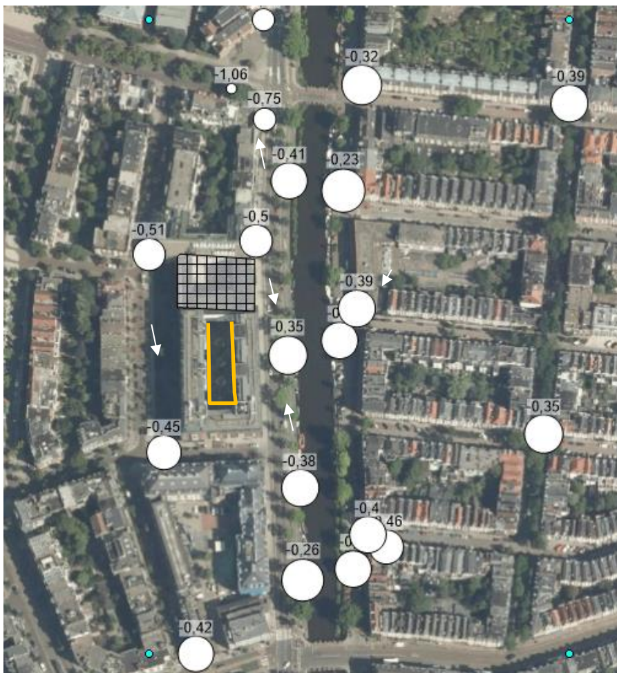
Figuur 6 - peilbuislocaties (omvang cirkel is de hoogte van de grondwaterstand, een grotere cirkel staat voor een hogere grondwaterstand). De pijlen betreffen de ingeschatte stromingsrichting tussen de bollen, de lengte van de peil staat voor de hoeveelheid grondwater.
