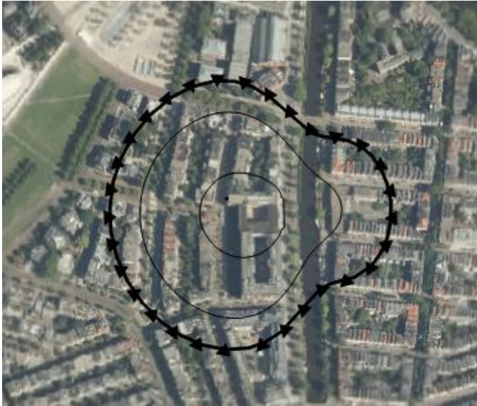
Figuur 4 - grondwaterstand t.o.v. NAP in wadzandlaag na 90 dagen spanningsbemaling (lijn met driehoeken is 0,05m verlaginglijn)
