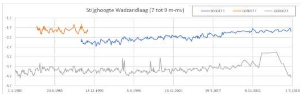
Figuur 3-3: Stijghoogte wadzandlaag. Gemiddelde C04057I = NAP -1,8 m.
