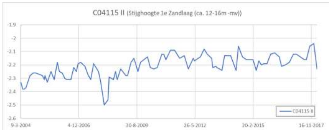
Figuur 3-2: Stijghoogte 1 e zandlaag. Hiervoor geldt dat: 95%percentiel = NAP -2,09m, gemiddelde waterstand = NAP -2,22 m en 5% percentiel = NAP -2,35m.
