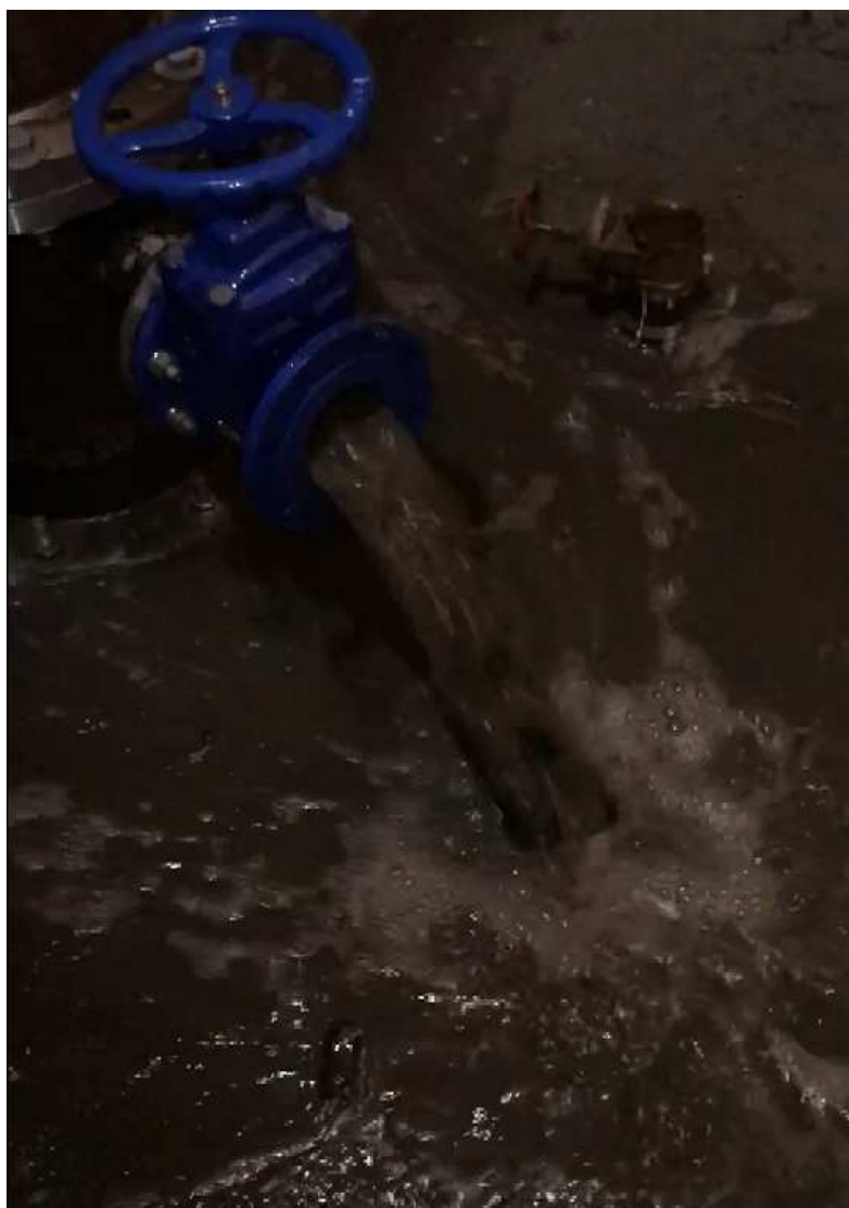
Figuur 4-2 Uitstroom uit afsluiter
