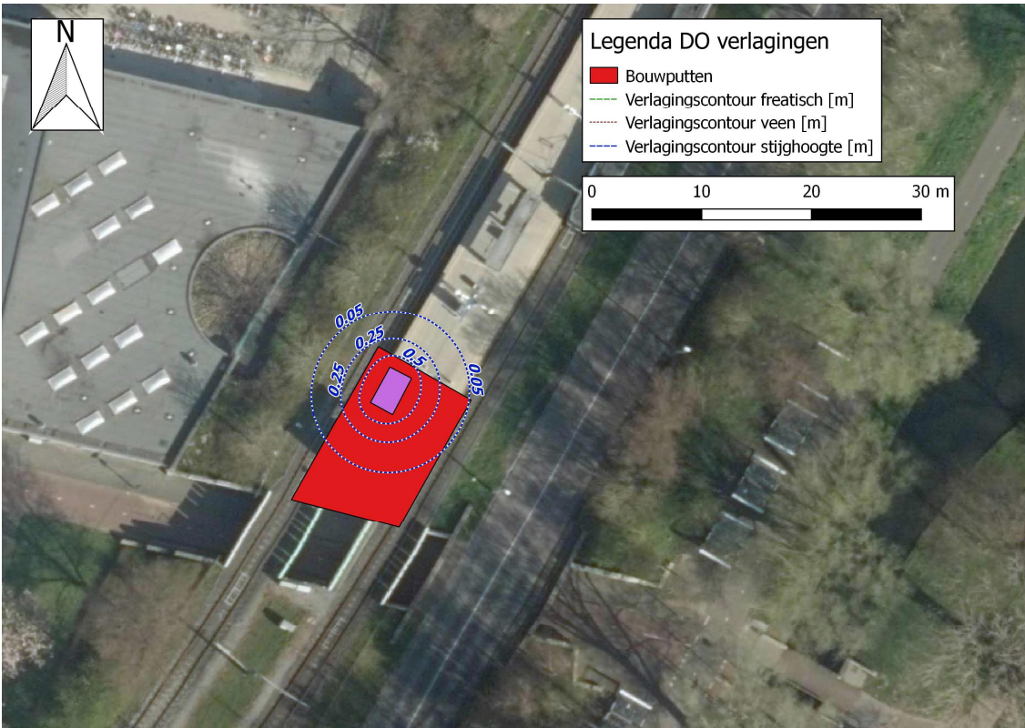
Figuur 35. Verlagscontour (stijghoogte, 1e WVP) halte Meent. In rood: bouwput en in paars: liftput.
