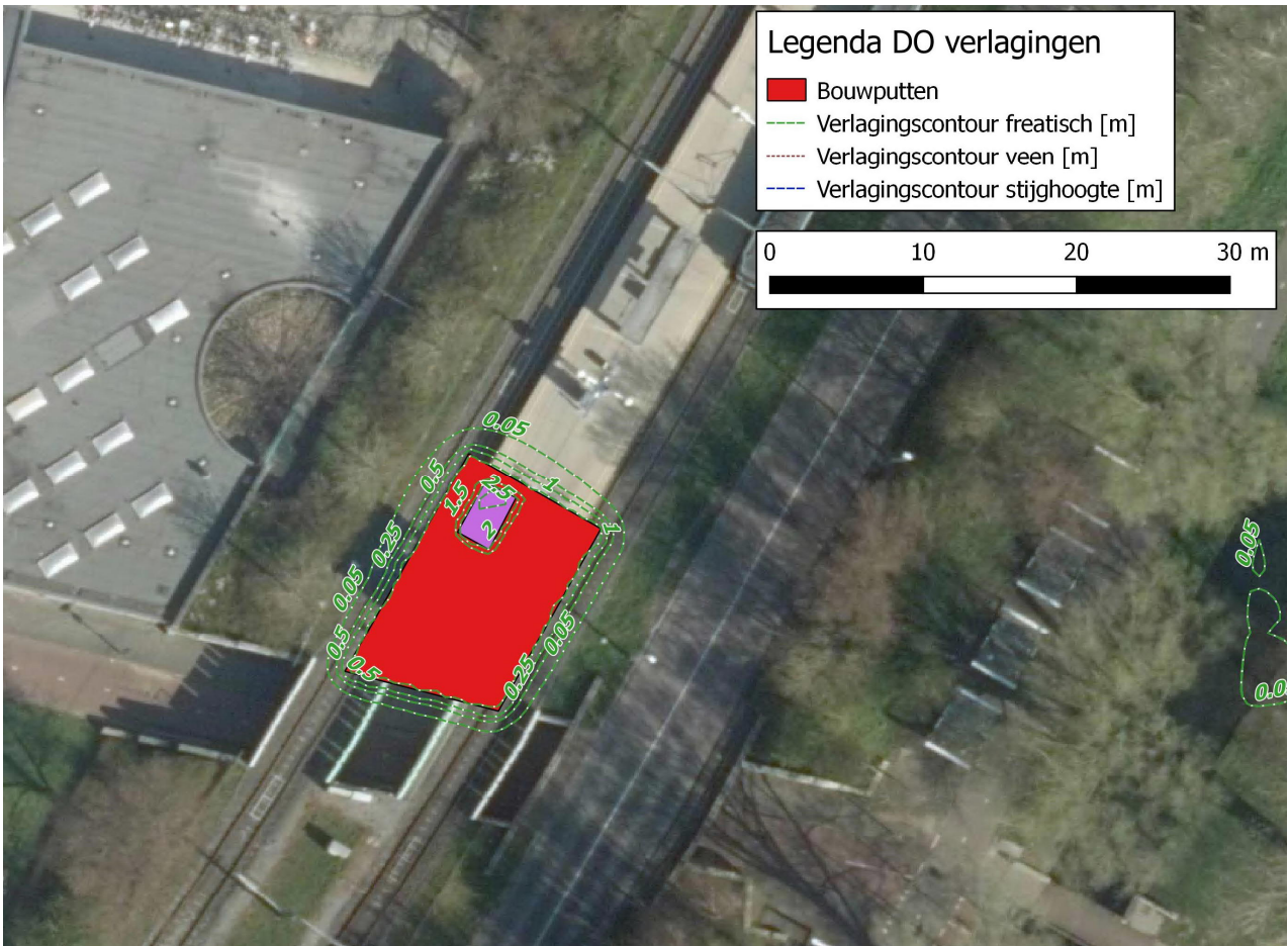
Figuur 33. Verlagingscontour (Freatisch) halte Meent. In rood: bouwput en in paars: liftput.
