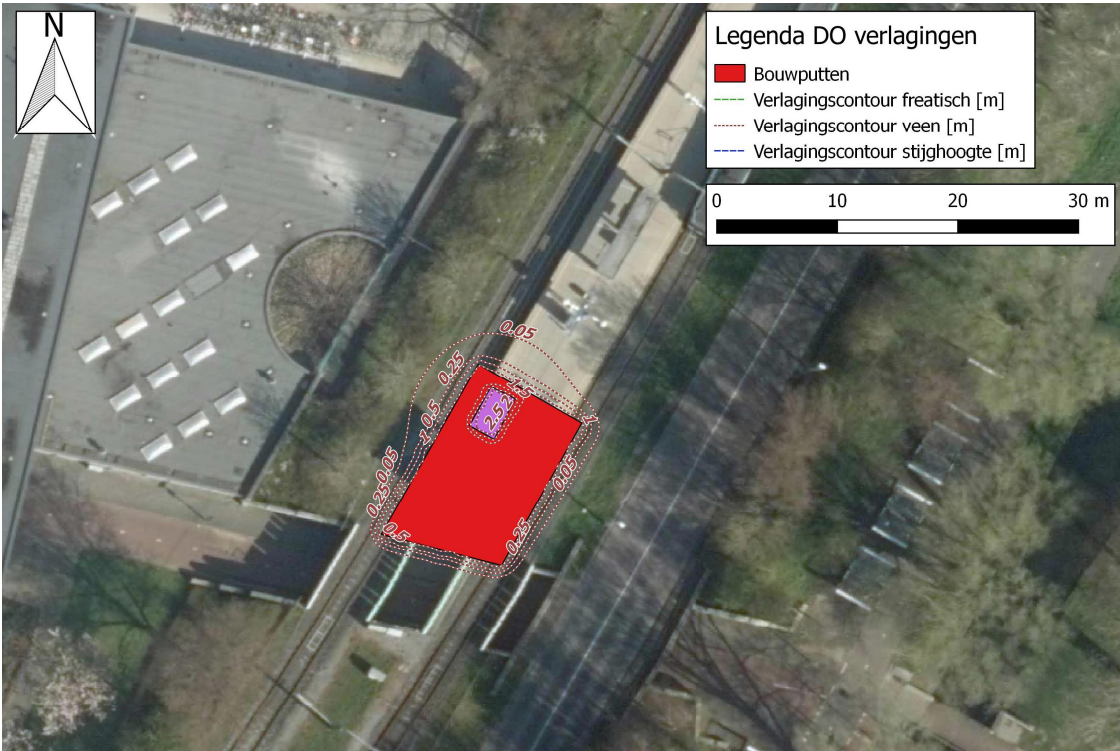
Figuur 34. Verlagscontour (Veen) halte Meent. In rood: bouwput en in paars: liftput
