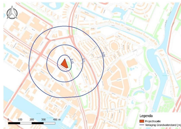
Figuur 5 Effect bemaling in de freatische watervoerende laag bij lage grondwaterstand
