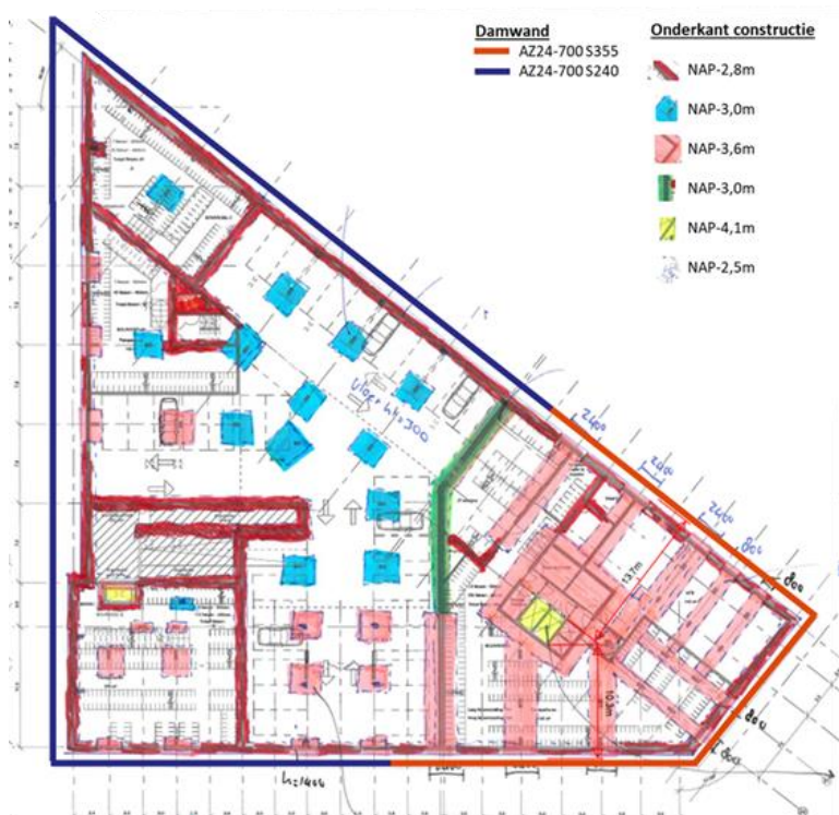
Figuur 3 Onderzijde constructie, conform [1][2][3]
