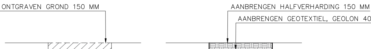
DETAIL 5: AANBRENGEN HALFVERHARDING SCHAAL 1:50
