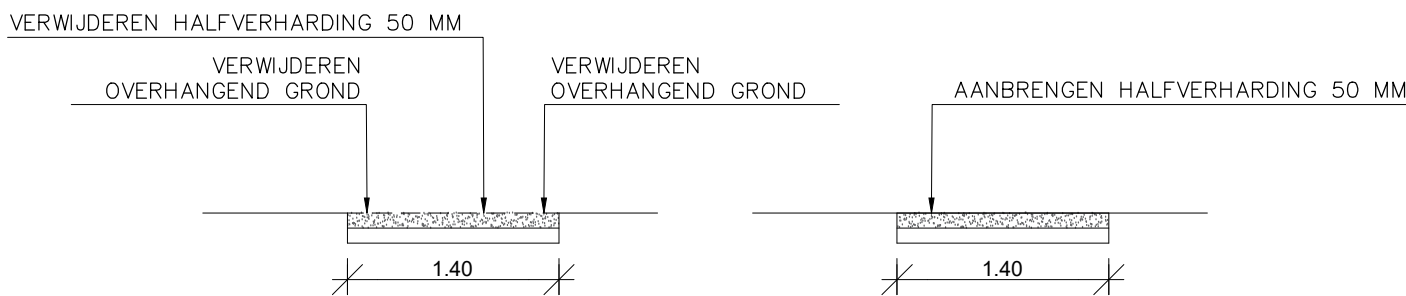
DETAIL 4: HERSTELLEN HALFVERHARDING SCHAAL 1:50
