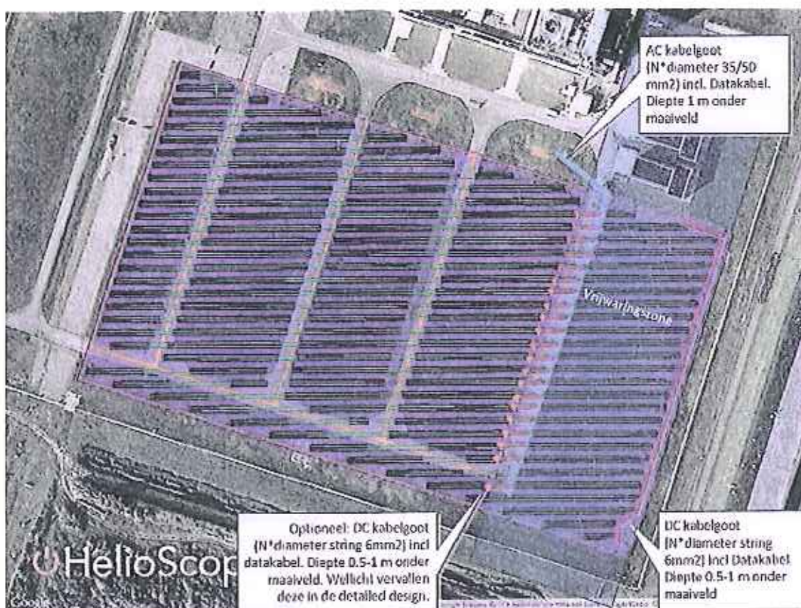
Figuur 3: Globale positie van kabels in de dijk-vrijwaringszone.
